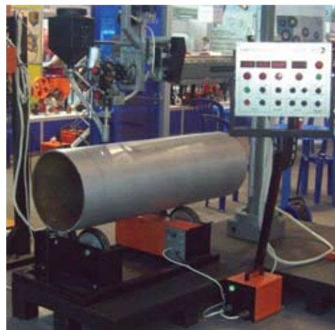
Сварочный центр состоящий из роликовых опор ОВРМ-1, колонны 1,5x1,5 м, сварочной головки АДФ-1000, крестообразных суппортов и единого пульта управления
