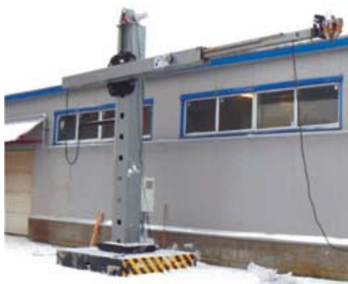
Колонна малой грузоподъемности (с выдвигной балкой)
